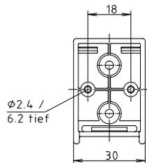
Verschraubung von Gehäuse-Aussenseite
